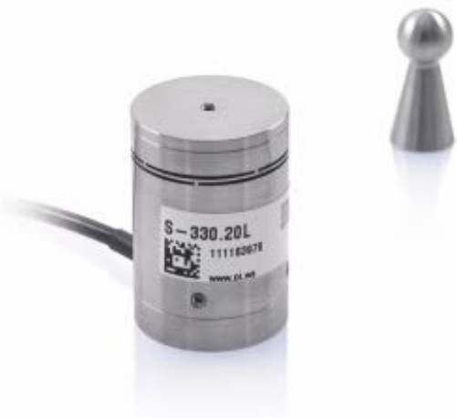
Abb. 1 Hochdynamische, piezogetriebene Kippplattform mit zwei orthogonalen Achsen und optischen Ablenkwinkeln von bis zu 20 mrad. Bis zu vier Piezoaktoren sind direkt mit der bewegten Plattform gekoppelt. Die Länge der Aktoren bestimmt den Kippwinkelbereich, das System ist daher skalierbar (Bild: PI)
